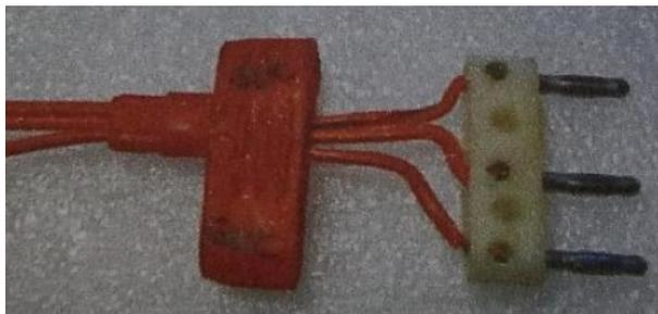
**Fil déconnecté du côté de la prise à 3 broches :** ces pannes sont dues à un arrachement accidentel : il faut démonter, recouper et rebrancher les fils sans les intervertir. Faire attention au sens de montage du capuchon.
